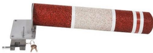
Obarajući stubovi prečnika 70 mm i visine 650 mm su izrađeni od gumenog granulata, sa nosećom čeličnom konstrukcijom od kvalitetnih livenih pocinkovanih elemenata. Stubovi se koriste za obeležavanje prostora na kojima je povremeno potreban prolazak vozila. Montaža se vrši četvorostrukim tipovanjem metalnog postolja u čvrstu podlogu. Obaranje i podizanje stuba je omogućeno preklapajućim mehanizmom sa katancem, tako da je rukovanje jednostavno i funkcionalno.
