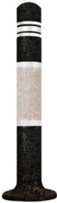
Stubovi prečnika 70 mm ili 100 mm, i visine od 650 ili 850 mm su predviđeni za montažu tiplovanjem u postojeću podlogu. Izrađeni su od gumenog granulata sa središnjim čeličnim nosačem, te su pogodni za obeležavanje parking mesta i ograničavanje travnatih i drugih prostora. Na vrhu poseduju jednu ili više reflektujućih traka, te se koriste za kao vizuelna ili mehanička zaštita.
